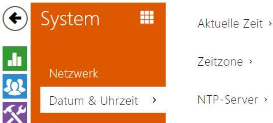
Wenn Sie die Einstellung der Zeitprofile für die Gültigkeitssteuerung der Telefonnummern, der Codes für das Einschalten der Schalter u.Ä. verwenden, müssen das interne Datum und die Uhrzeit im Interkom richtig eingestellt sein.
