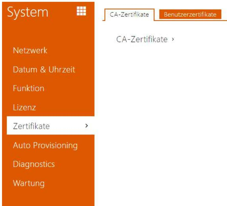
Manche Netzleistungen des **2N IP Interkoms** nutzen für die Kommunikation mit anderen Anlagen im Netz das gesicherte TLS-Protokoll. Dieses Protokoll verhindert, dass der Inhalt der Kommunikation von Dritten abgehört ggf. zu modifiziert wird. Beim Anknüpfen der Verbindung mittels des TLS-Protokolls läuft eine einseitige bzw. beidseitige Authentifizierung, die Zertifikate und private Codes erfordert.
