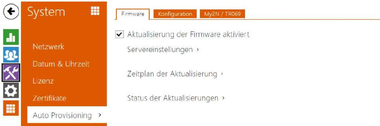
Die **2N IP Interkoms** ermöglichen außer der manuellen Aktualisierung der Firmware und der Konfiguration auch die Firmware und Konfiguration gemäß den festgelegten Regeln vom Speicherplatz in dem durch Sie definierten TFTP- oder HTTP-Server automatisch herunterzuladen und zu aktualisieren.
