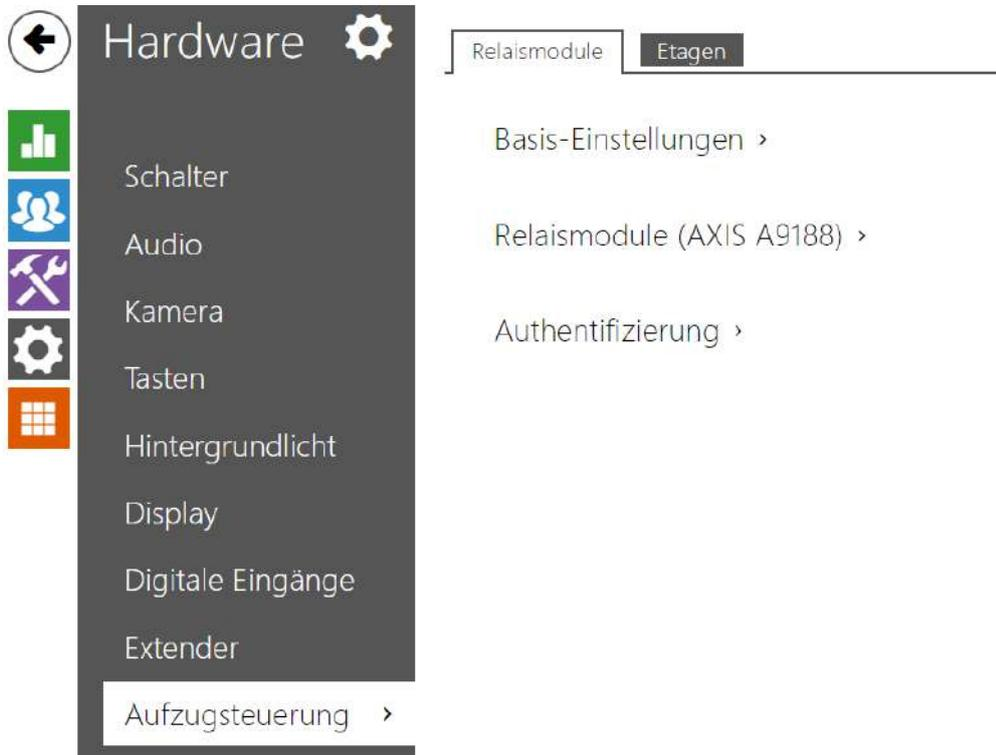
Durch Anschließen des Relaismoduls AXIS A9188 zur 2N IP Sprechanlage (**2N IP Style, 2N IP Verso, 2N IP Force, 2N, IP Safety, 2N IP Vario**) kann man den Zutritt auf einzelne Etagen mit Aufzug steuern. Zu einer 2N IP-Sprechanlage kann man max. 8 solche Relaismodule anschließen, dabei jeder der Module 8 Etagen bedienen kann, insgesamt also 64 Etagen.
