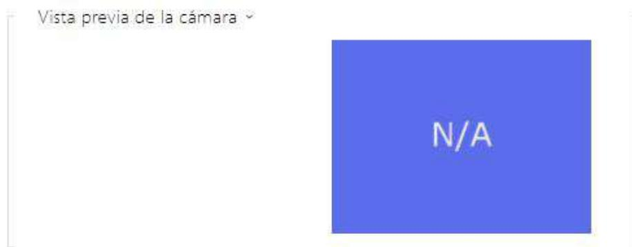
En la ventana Vista previa de la cámara se muestra la imagen actual recibida de la cámara externa. En el caso de que la cámara externa no esté conectada o configurada correctamente, aparecen símbolos N/A sobre un fondo azul.
