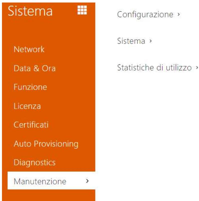
Este menú sirve para el mantenimiento de la configuración y del firmware del intercomunicador. Permite respaldar y restaurar la configuración de todos los parámetros, actualizar el firmware del intercomunicador, event. configurar todos los parámetros del intercomunicador a estado inicial.
