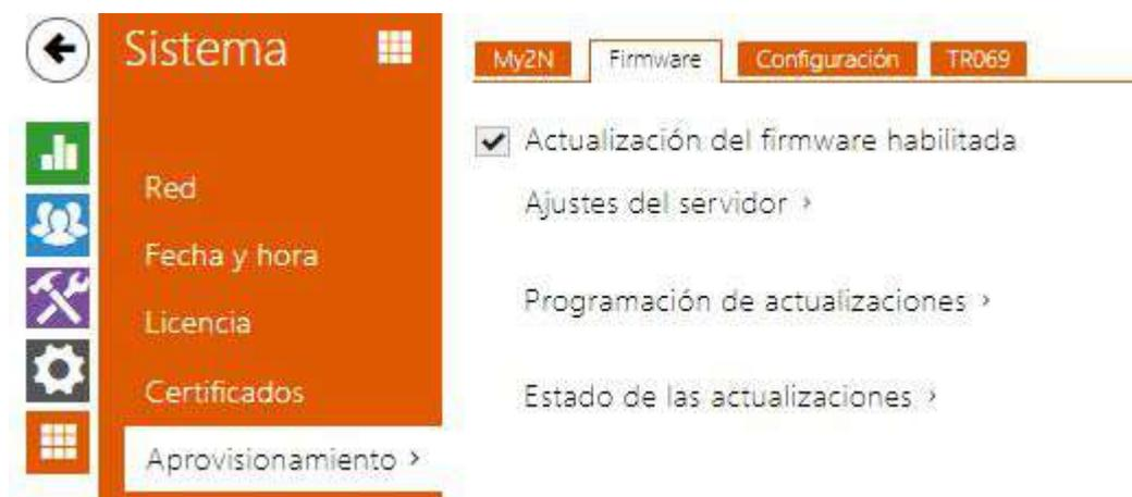
Los **intercomunicadores 2N IP** permiten, a parte de la actualización manual del firmware y de la configuración, también descargar y actualizar el firmware y la configuración, según las reglas establecidas, desde el almacenamiento al servidor TFTP o HTTP definido por usted.
