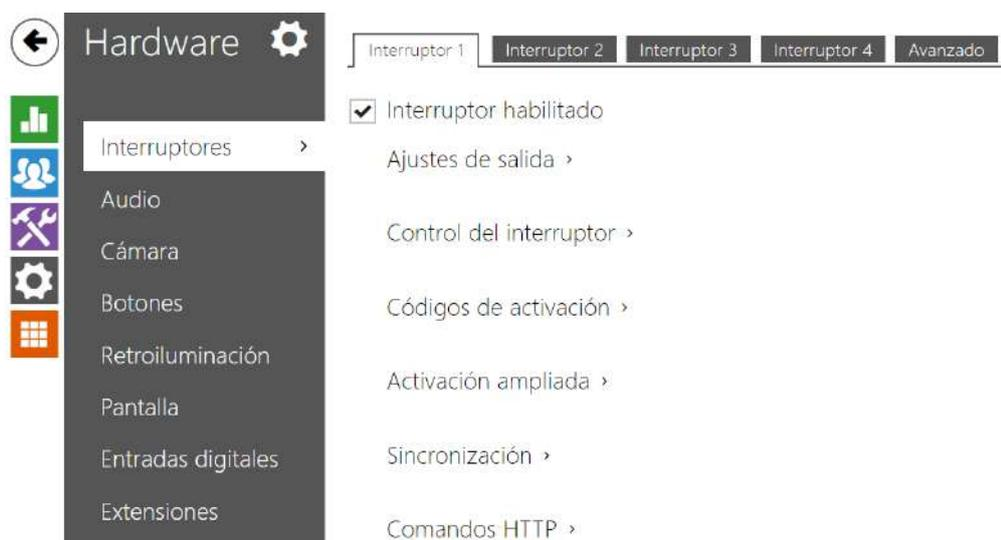
Los interruptores permiten el control muy flexible de diferentes periféricas conectadas al intercomunicador (como son las cerraduras de puerta eléctricas, iluminación, señalización adicional del sonido del timbre, etc.).
