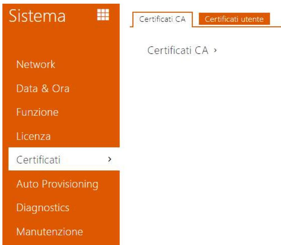
Algunos servicios de red del **intercomunicador 2N IP** utilizan para la comunicación con otros dispositivos en la red el protocolo TLS asegurado. Este protocolo impide a terceros realizar escuchas, event. modificar el contenido de la comunicación. Durante el establecimiento de la conexión mediante el protocolo TLS se realiza la autenticación de una parte, event. de ambas partes, que requiere certificados y claves privadas.
