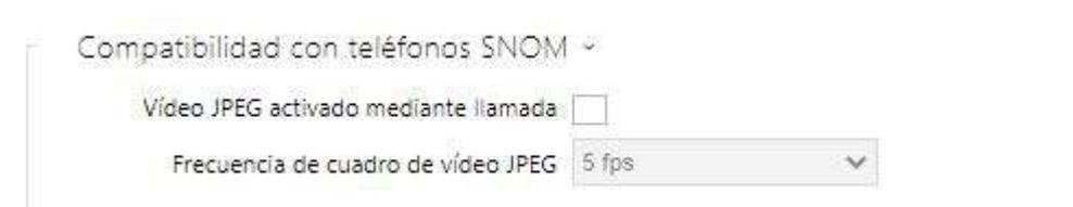
Algunos teléfonos IP (SNOM 820/870) no soportan las llamadas de vídeo, pero son capaces durante la llamada descargar y mostrar periódicamente las imágenes JPEG descargadas desde la dirección IP definida. Los intercomunicadores **2N IP** soportan esta función y usted la puede configurar en esta solapa.
