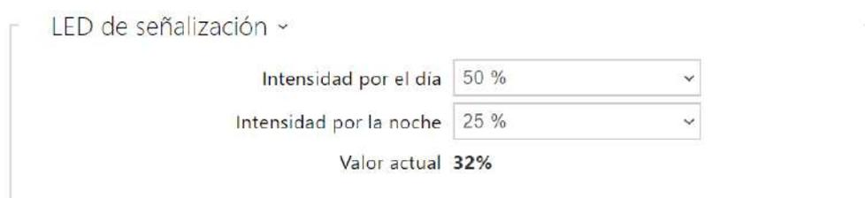
Las configuraciones de los parámetros en el grupo de LED de señalización son válidos para los LED de señalización (retroiluminación del lector de **2N IP Style**).
