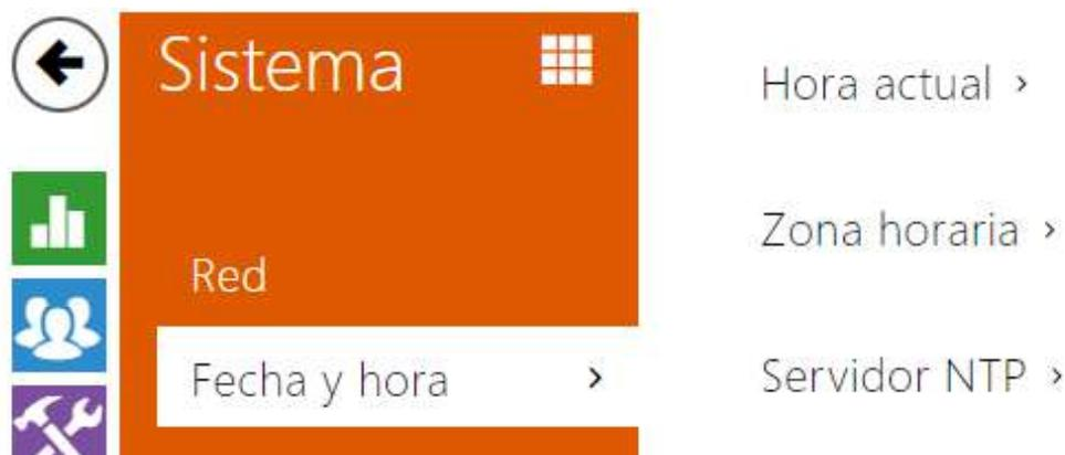
En el caso de que esté utilizado la configuración de los perfiles de tiempo para controlar la validez de los números de teléfono, códigos para la activación de la cerradura, etc., es imprescindible que el intercomunicador tenga configurada correctamente la fecha y la hora interna.
