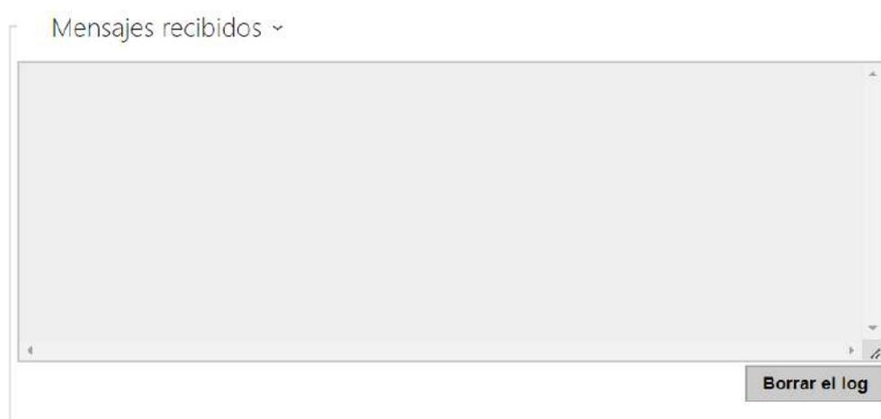
Ventana Mensajes recibidos sirve para obtener la cadena de definición. Al acercar la tarjeta de acceso al lector del intercomunicador 2N IP aparecerá la definición de la señalización OSDP del dispositivo de la parte opuesta para el acceso autorizado o no autorizado.
