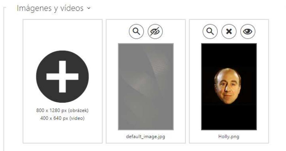
El tamaño de las imágenes cargadas debería ser 800 x 1280 píxeles para los modelos **2N IP Style**. En el caso contrario se adaptarán de forma automática a la resolución de la pantalla. Los archivos de vídeo deben tener la resolución de 400 x 640 px, tamaño máximo de 7 MB y framerate máximo de 24 fps. En el caso de que no haya ninguna imagen cargada, el modo de presentación no se activará jamás.
