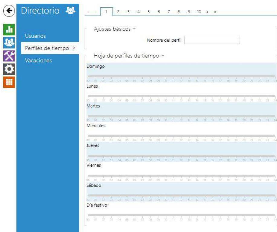
En determinadas funciones del intercomunicador, como por ej. llamada saliente, acceso mediante la tarjeta RFID o código numérico, se puede limitar el tiempo. A las funciones mencionadas se puede asignar el llamado **perfil de tiempo**, que determina cuando la función
