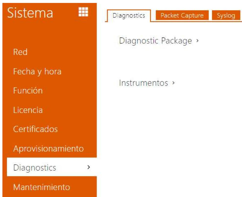
El **intercomunicador 2N IP** permite enviar los mensajes de sistema, que contienen la información importante sobre el estado y procesos del dispositivo, al servidor syslog donde se pueden registrar estos mensajes u utilizar para el siguiente análisis y audit del dispositivo monitorizado. En la operación habitual del intercomunicador no es necesario configurar este servicio.
