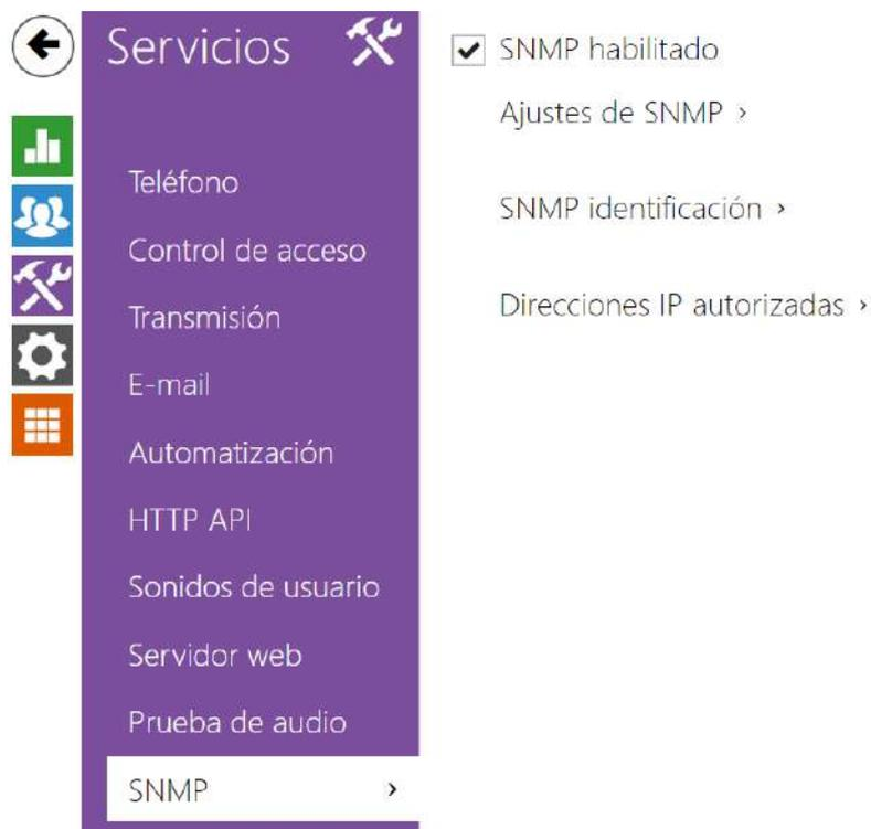
Los **intercomunicadores 2N IP** integran la funcionalidad que permite la vigilancia remota de los intercomunicadores en la red mediante el protocolo SNMP. El agente SNMP integrado en el dispositivo está disponible tras introducir la clave de licencia con la licencia **Enhanced Integration**. Los intercomunicadores soportan el protocolo SNMP versión 2c.
