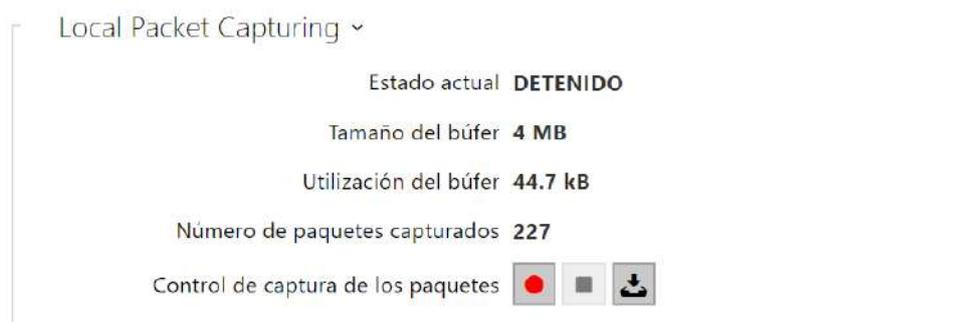
Cuando el búfer está lleno durante la captura local, los paquetes almacenados más antiguos se sobrescriben automáticamente. Al captar paquetes de forma local, recomendamos reducir la velocidad de transmisión del video por debajo de 512 kbps. La captura la puede iniciar mediante
