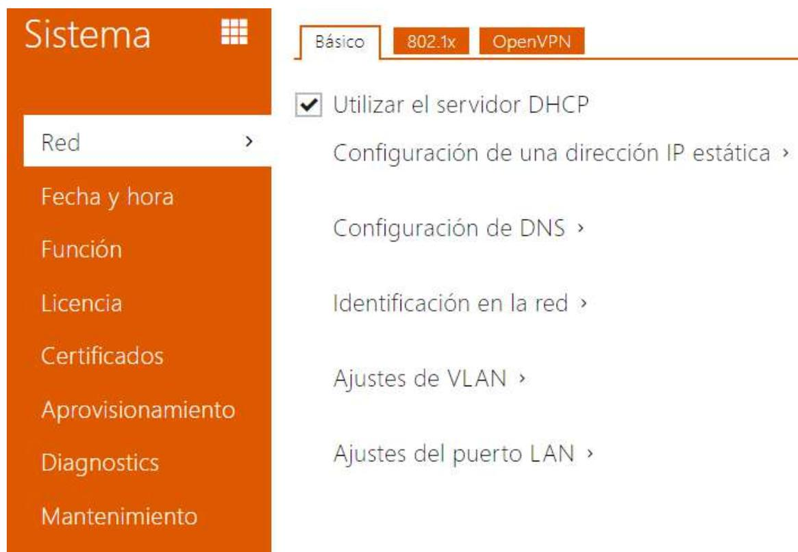
El **intercomunicador 2N IP** se conecta a la red local y para un funcionamiento correcto debe tener configurada la dirección IP válida, event. puede obtener la dirección IP desde el servidor DHCP en esta red. La dirección IP y la configuración de DCHP se configura en la solapa Red.
