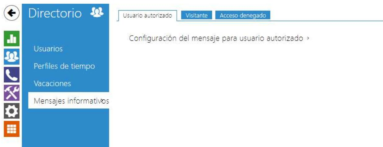
El dispositivo 2N IP Style puede en su pantalla mostrar mensajes informativos que se pueden preconfigurar. De esta forma los usuarios o los visitantes que estén parados junto al dispositivo pueden ser guiados por el edificio mediante el mensaje en la pantalla, pueden ser informados sobre los sucesos que ocurren en el edificio etc.
