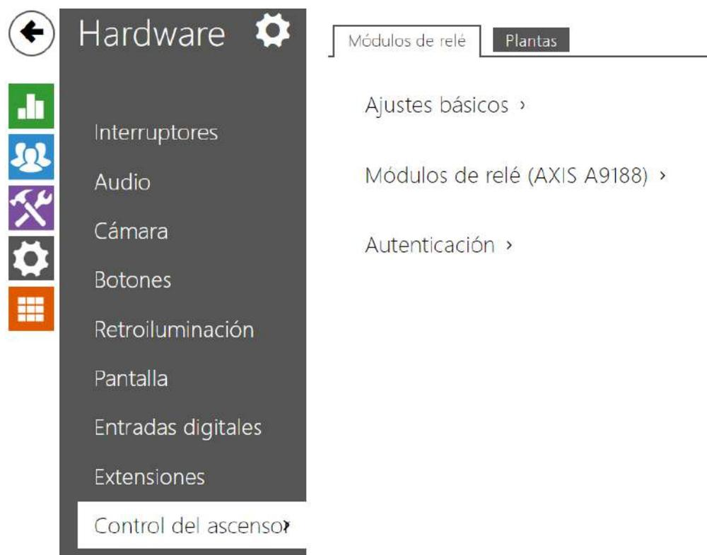
Mediante la conexión del módulo del relé AXIS A9188 al intercomunicador 2N IP (**2N IP Style, 2N IP Verso, 2N IP Force, 2N IP Safety, 2N IP Vario**) se puede controlar el acceso a cada una de las plantas en el edificio en el caso de utilizar el ascensor. A un intercomunicador 2N IP se pueden conectar como máximo 8 de estos módulos de relé, cada módulo puede controlar 8 plantas, es decir, en total un máximo de 64 plantas.
