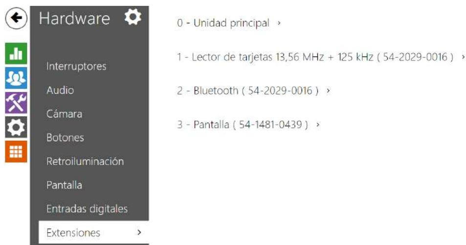
Los intercomunicadores **2N IP Verso** y **2N IP Style** se pueden ampliar mediante los llamados módulos de ampliación conectados a la unidad básica del intercomunicador a través del colector VBUS. Disponibles están los siguientes módulos:
