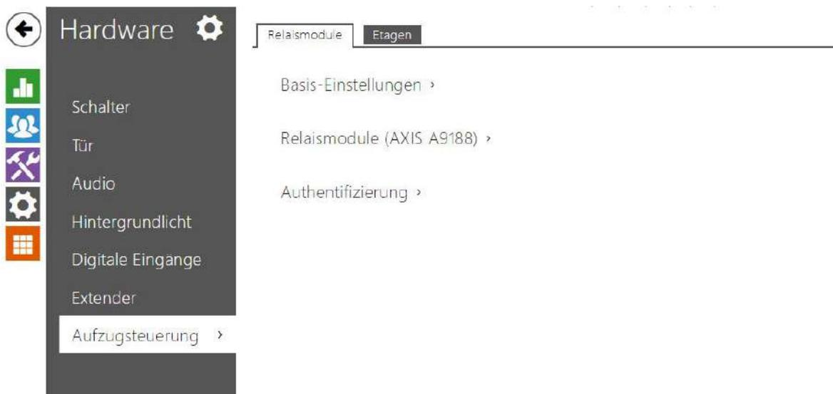
Durch den Anschluss des Relaismoduls AXIS A9188 an das Gerät kann der Zugang zu einzelnen Etagen eines Gebäudes über den Aufzug gesteuert werden. Es können maximal 5 dieser Relaismodule an ein Gerät angeschlossen werden, wobei jedes Modul 8 Etagen steuert, also insgesamt 64 Etagen.
