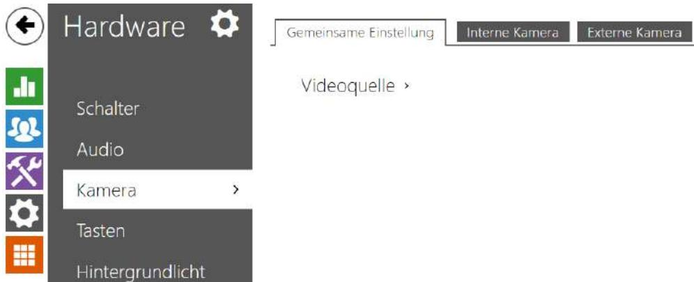
Dieses Menü ist nur bei 2N Geräten verfügbar, die mit einer internen Kamera ausgestattet sind oder den Anschluss einer externen Kamera erlauben - 2N Access Unit QR. Das Kamerasignal kann per E-Mail versendet, über das ONVIF/RTSP-Protokoll an ein anderes Gerät gestreamt (z.B. Videoüberwachung) oder einfach als JPEG-Bilder über das HTTP-Protokoll vom Gerät heruntergeladen werden.
