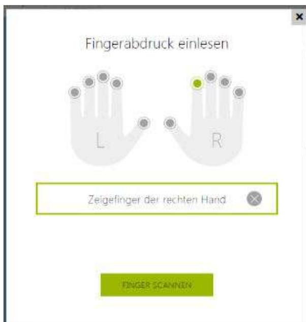
**4)** Legen Sie den gewählten Finger an den externen USB-Scanner an. Für eine höhere Genauigkeit wird dieser Prozess insgesamt dreimal wiederholt.
