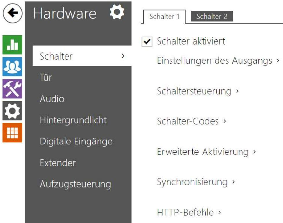
Die Schalter ermöglichen eine sehr flexible Steuerung von verschiedenen Geräten (wie die elektrische Türschlösser, Beleuchtung, Ergänzungssignalisierung des Klingelns u.Ä. sind). Das Gerät ermöglicht 2 unabhängige Schalter zu konfigurieren, die man für beliebigen Zweck benutzen kann.
