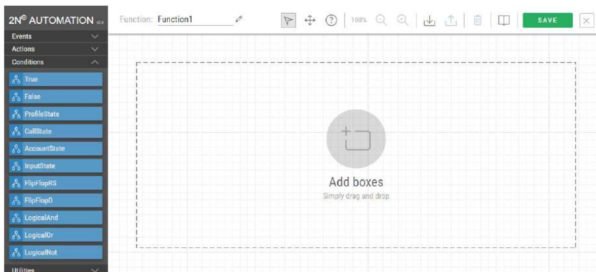
**Colonne de Bloc de la fonction** – elle comprend quatre groupes de blocs : Evénements, Actions, Conditions et Utilités. Il suffit de déplacer les blocs sur la fenêtre du milieu.
