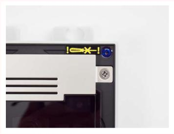
• L'unité principale ne doit pas être retirée de sa base, ne retirez donc pas la vis recouverte de résine indiquée dans le coin supérieur droit. Toute manipulation de la vis entraîne une perte de la garantie de l'appareil.
