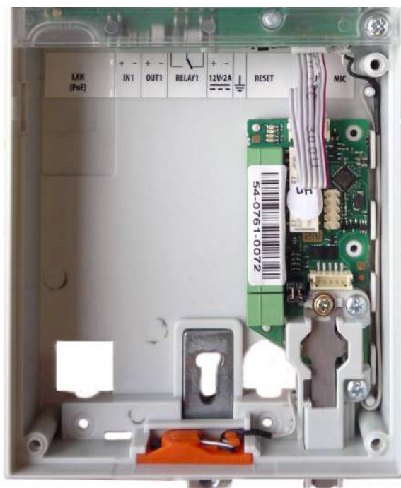
Bild: Montage des Schutzschalters
