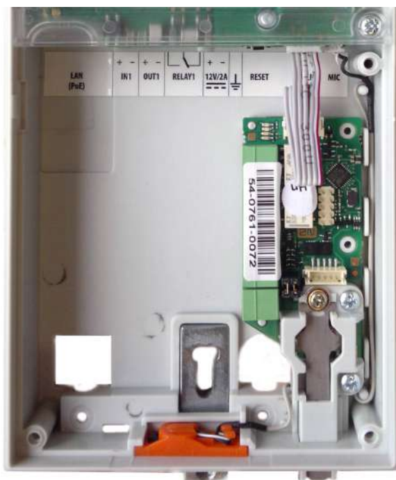
Obrázek: Montáž ochranného spínače
