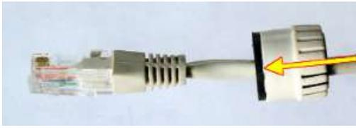
5. Faire passer le connecteur du câble au travers du presse-étoupe et le connecter au PCB de l'interphone à l'emplacement prévu comme indiqué sur la photo ci-dessous.
